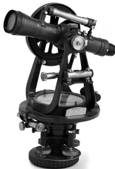
●写真2 創業当時の測量機 トーカー三吋半トランシット
