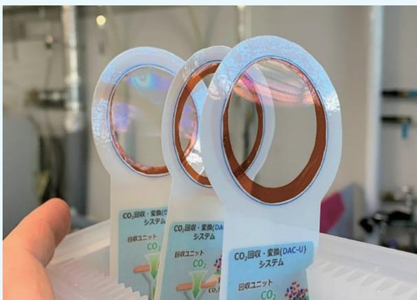
図1 世界最高性能のCO<sub>2</sub>透過性を持つ自立ナノ膜
